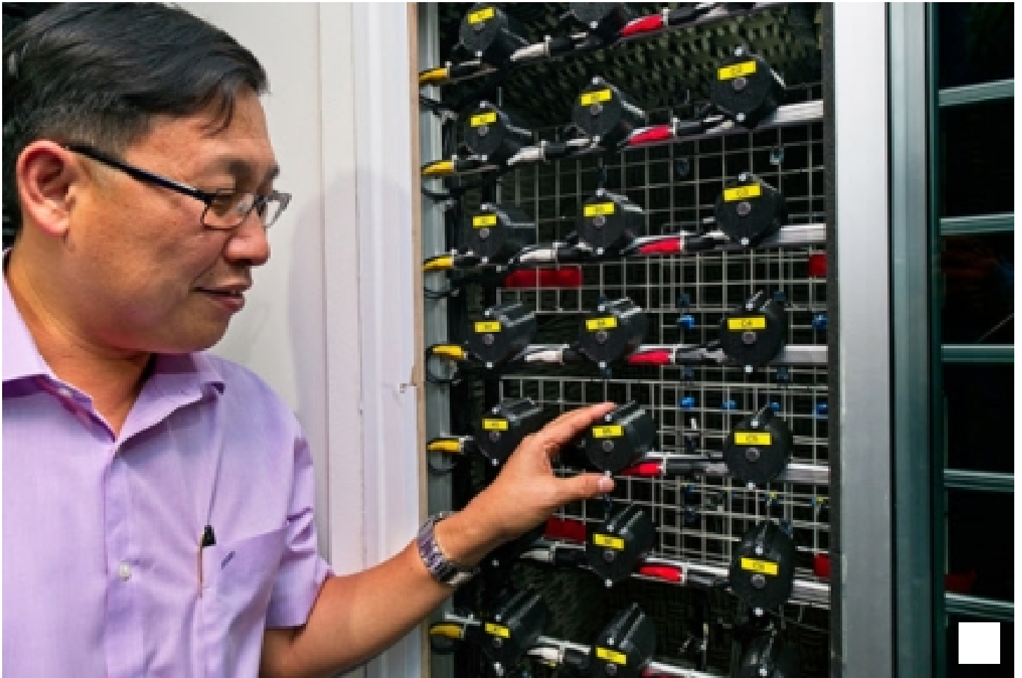
싱가포르 난양공대의 윤-생 간 교수가 방법창 창살에 설치된 소음 상쇄용 스피커를 점검하고 있다. 이 장비로 도로에서 발생하는 소음을 절반으로 줄였다./NTU
